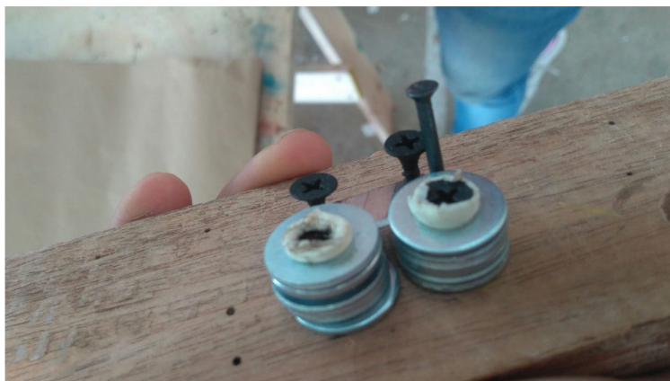
Herramienta elaborada para cortar el hilo de PET
