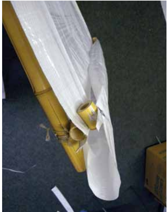
(P89 - P91) Tarpaulin cnister interface (P92) Tapulin gutter
