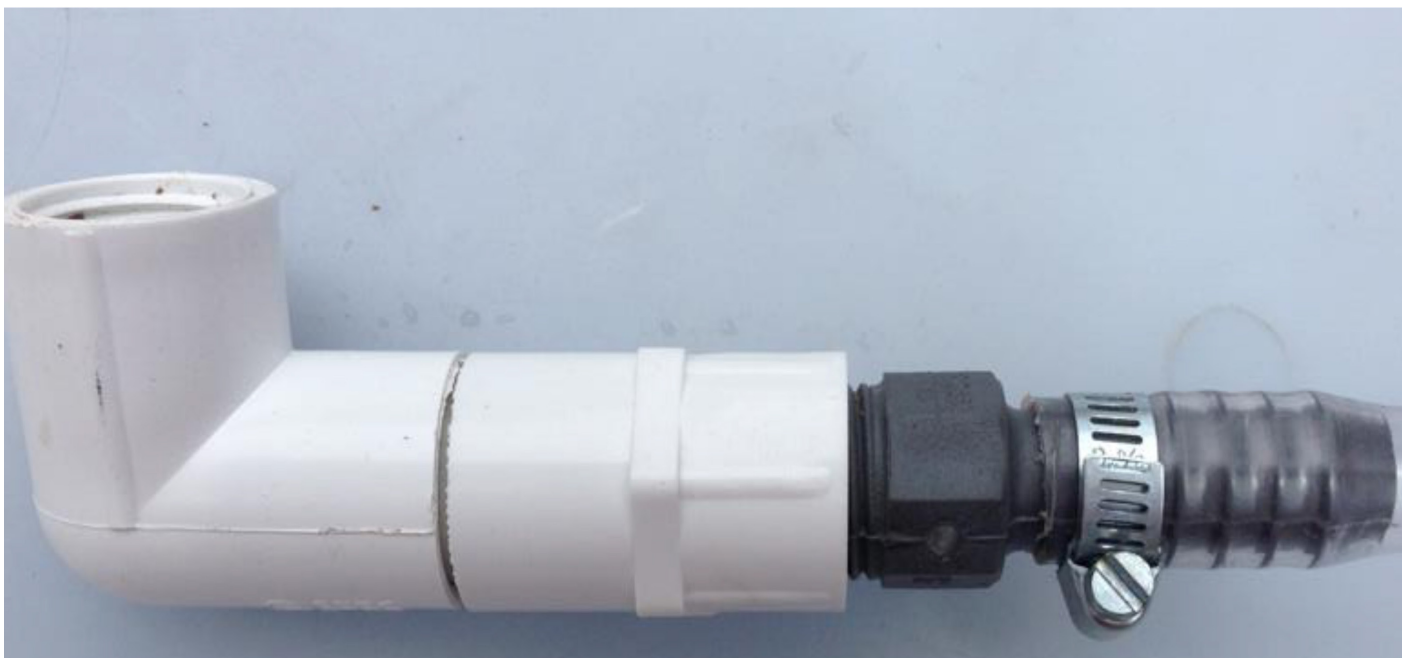
Adaptación mejorada de la unión del tubo al tanbo para evitar fugas
